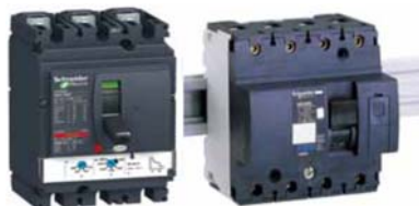
Figura 8 : Automatë magnetotemikë LSI dhe LSIG, tre dhe katër polarë sipas CEI 60947-2, të përdorur në kompozimin e Panelit Elektrik Kryesor dhe Panelin Elektrik Shpërndarës
