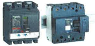
Figura 4 : Automatë magnetotermikë LSI dhe LSIG, tre dhe katër polarë sipas CEI 60947-2, te përdorur në kompozimin e Panelit Elektrik Kryesor dhe Panelin Elektrik Shpërndarës
