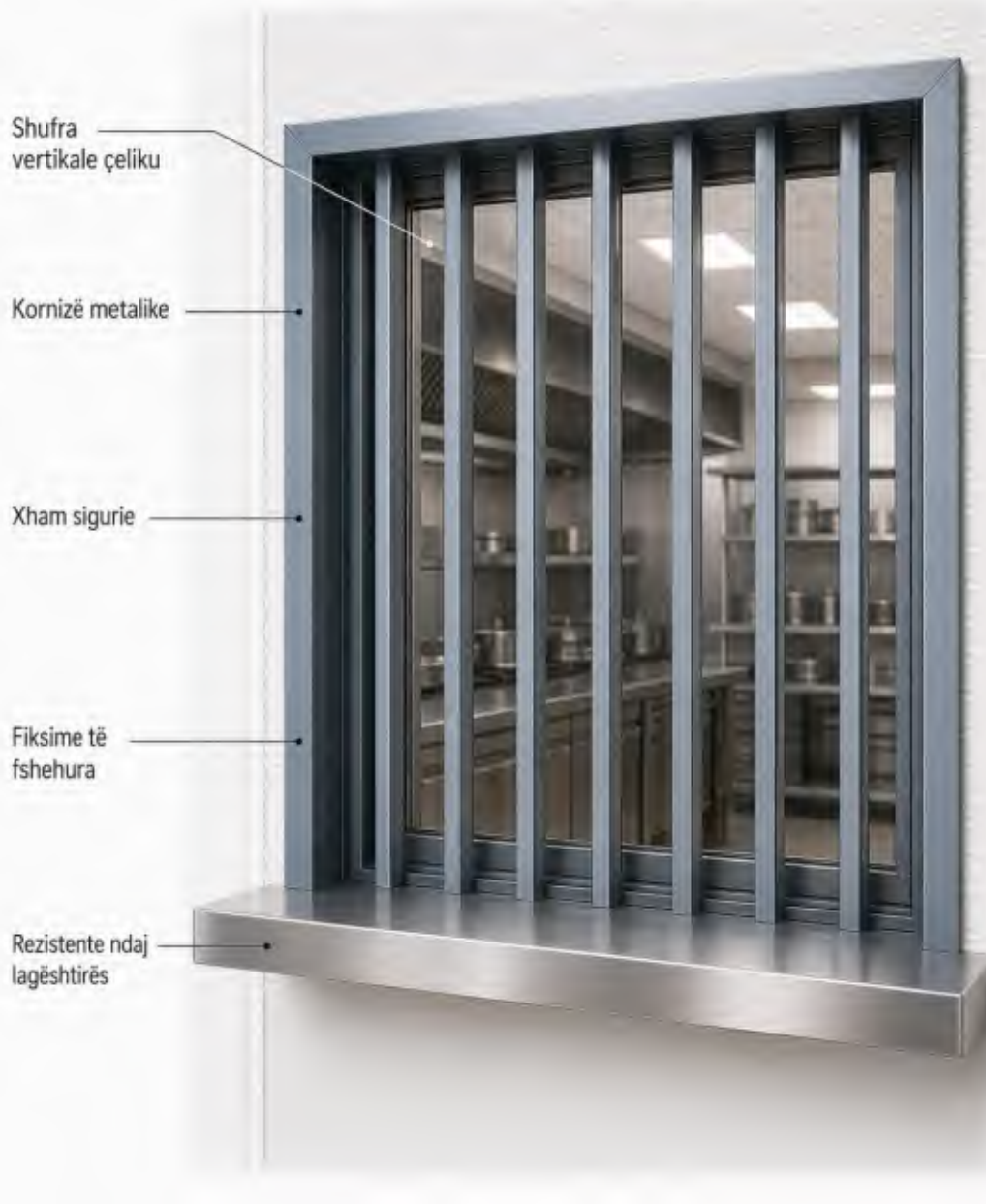
Figura 7.15-05C. EM-01 – Zgarë mbrojtëse vertikale për dritare kuzhine.
