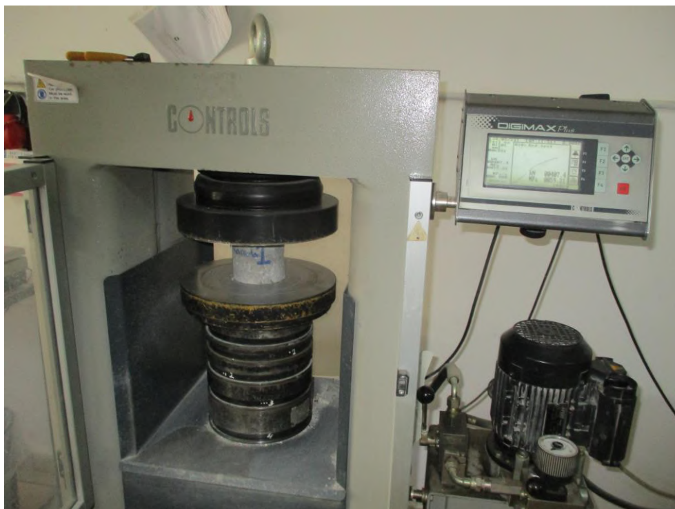
Fig 33. Testimi I karrotave te betonit per percaktimin e rezistences ne shtypje
