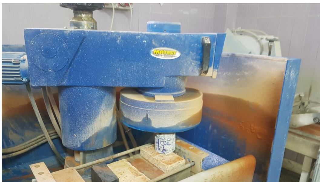
Fig 32. Përgatitja, Rrafshimi i sipërfaqeve te karrotave te betonit me pajisjen e posacme rrafshuese
