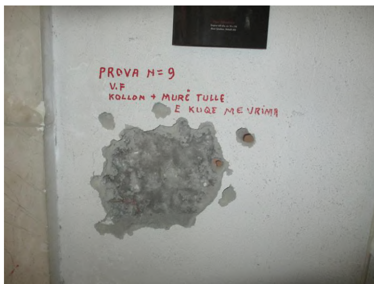
Fig 24. Pozicioni Nr 9, Mur me tulla te lehtesuara ne aksin C'30-B30 kati 1
