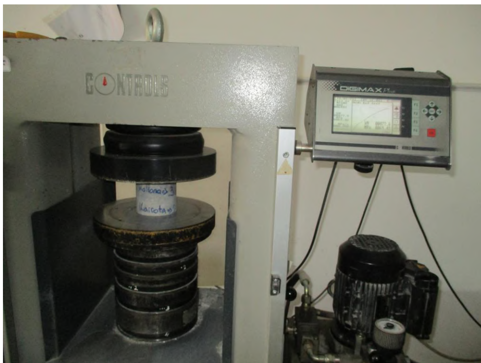
Fig 34. Testimi I karrotave te betonit per percaktimin e rezistences ne shtypje
