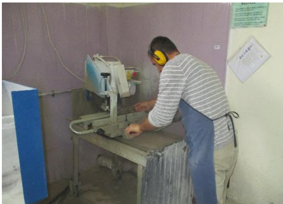
Fig 31. Përgatitja, prerja e karrotave te betonit ne lartesine e kerkuar
