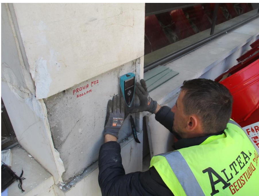
Fig 17. Kolona ne aksin D9' Kati 0, Skanimi i armatures / Përcaktimi i Shtresës mbrojtëse të betonit
