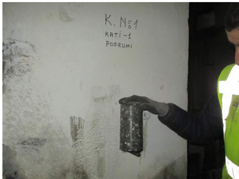
Fig 2. Pozicioni Nr 1, Marrja e mostrave te karrotave te betonit
