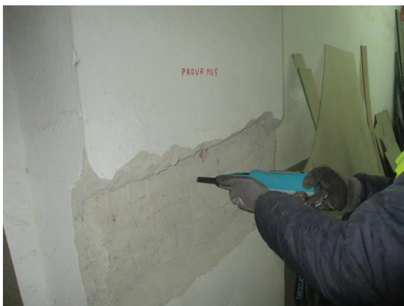
Fig 12. Pozicioni Nr.5, Prova pa shkatërrim me Sklerometer
