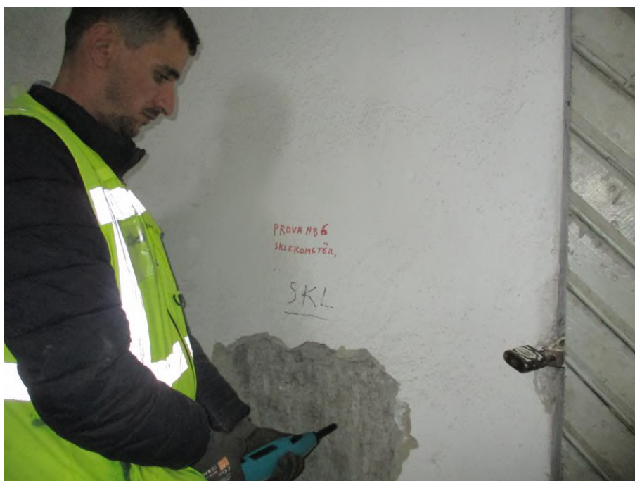
Fig 14. Position no 6, Prova pa shkatërrim me Sklerometer
