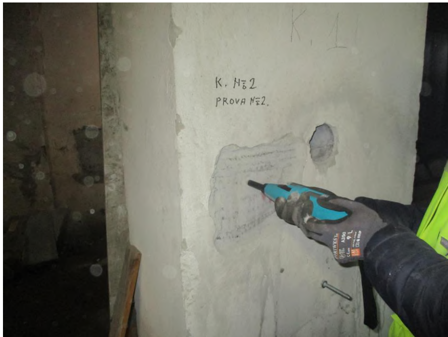
Fig 4. Pozicioni Nr.2, Prova pa shkaterrim me Sklerometer
