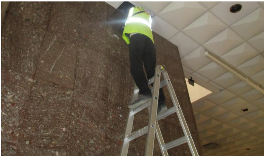
Fig 18. Pozicioni Nr.3, Kollona ne aksin C12, kati 0, Prova pa shkaterrim me Sklerometer
