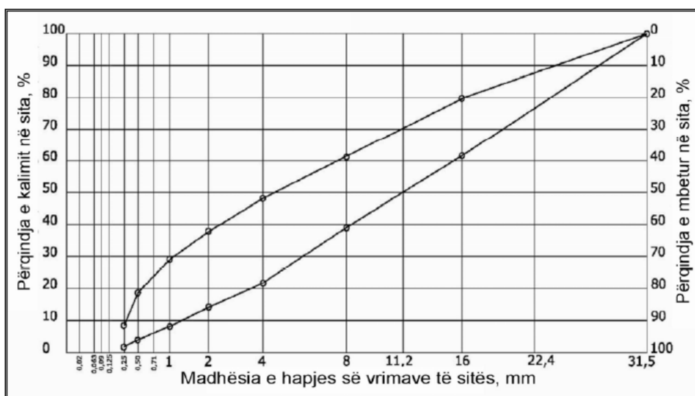
Figura 5.3: Zona e kompozimit të përzierjeve të kokrrizave të gurta për përzierje betoni CB 32.
