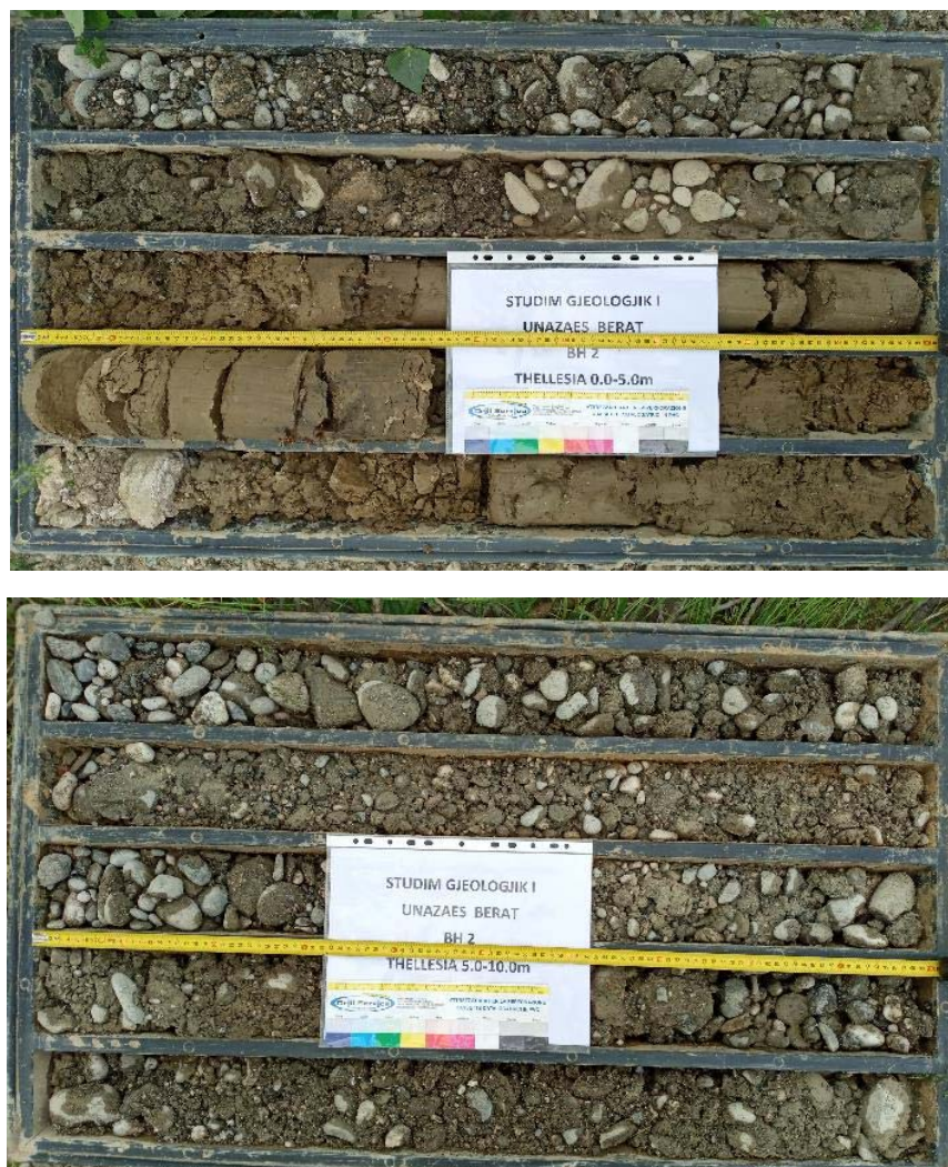
Figura 18 – Foto te Kampionit te marre nga Sonda Nr.2
