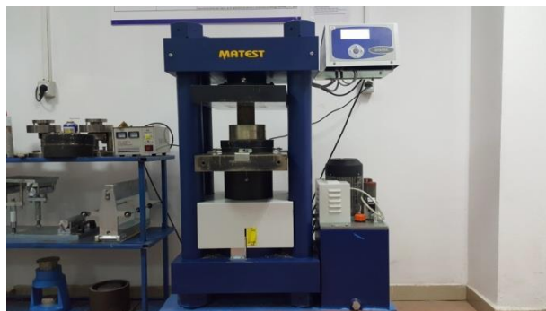
Figure 10 – Kampioni ne procesin e proves se rezistences nje boshtore
