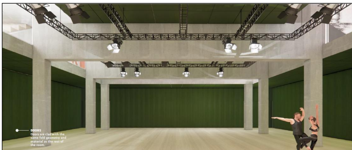
Figura 13 : Veshja e mureve të lehtësuara dhe panelet e tavanit absorbues , ekstrakti i vizatimit të Architect / A = Troldekt ose të ngjashëm - B = panele MDF
