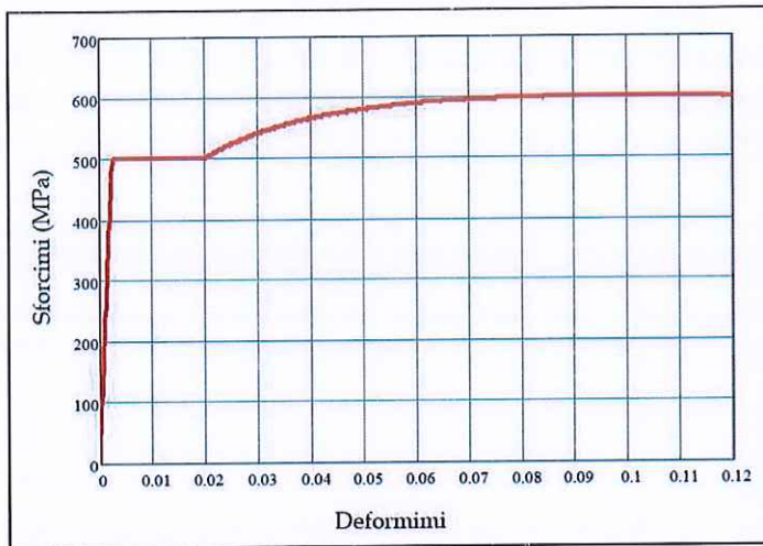
- Diagrama sforcim-deformim e çelikut B500C
