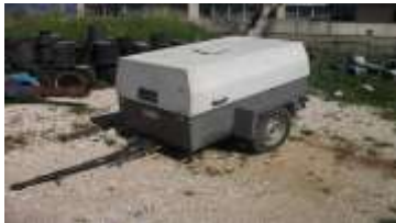
Kompresori " Bottarini" MSC43 me motor Lombardini LDW 1204
