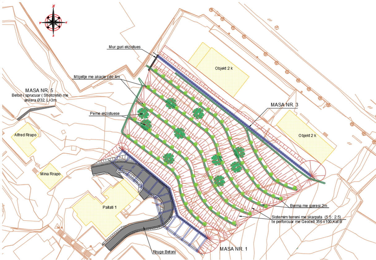
Figura 53– Stabilizim i skarpatave me Geocell dhe berma dhe mbjellje me akacie
