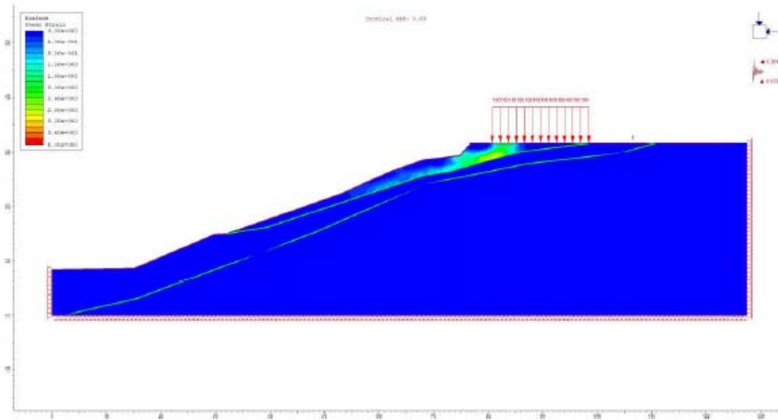
Figura 18 - Llogaritjet gjeoteknike, masat 1 dhe 3, nivel i ulet uji, me veprim sizmiciteti, FS = 0.83
