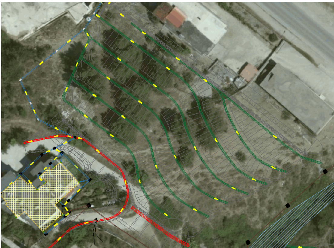
Figura 16- Masat hidroteknike për sistemimin e ujrave rreth zonës së pallatit nr.1
