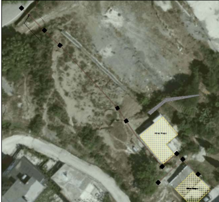
Figura 17- Sistemi i kanalizimeve te ujrave te perdorura Pallati 1
