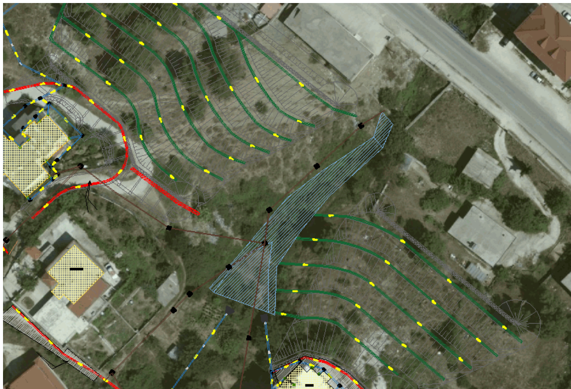
Figura 22- Sistemet e kanaleve në skarpatat e sistemuara me taraca
