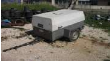
Kompresori " Bottarini" MSC43 me motor Lombardini LDW 1204
