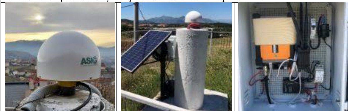
Figurat 2.2.2–2.2.4 – Komponentët përbërës të Rrjetit Shtetëror Aktiv të Pozicionimit Global (ALBCORS)
