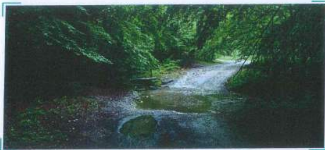
Fotografia 3: Një lug i bërë prej betoni ose guri duhet të parashihet në fazën e planifikimit për kallimino një përroi sikurse ky që është paraqitur më sipër (Fotografia: Juri Begu)
