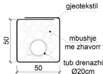
Fig. 6.7 Paketa drenuese pas murit mbajtës dhe perde me pilota
