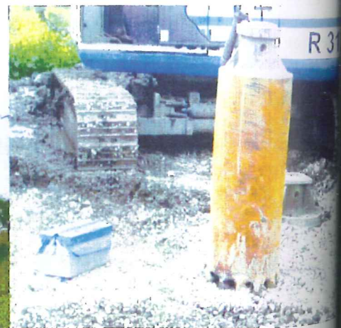
foto I.1. Sonda e kryerjes së shpimit dhe instrumenti shpues
