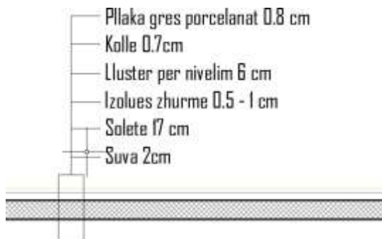
Figure 8 Shtresat përbërëse të soletës
