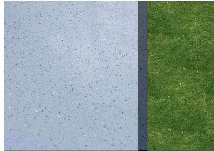
DETAJI 1__Fragment shtrimi beton me agregat ne dukje dhe gjelberim
