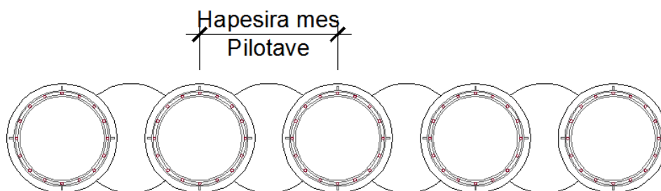
Fig. 3 Pilota sekante (te armuara/te paarmuara me rezistence te ulet)
