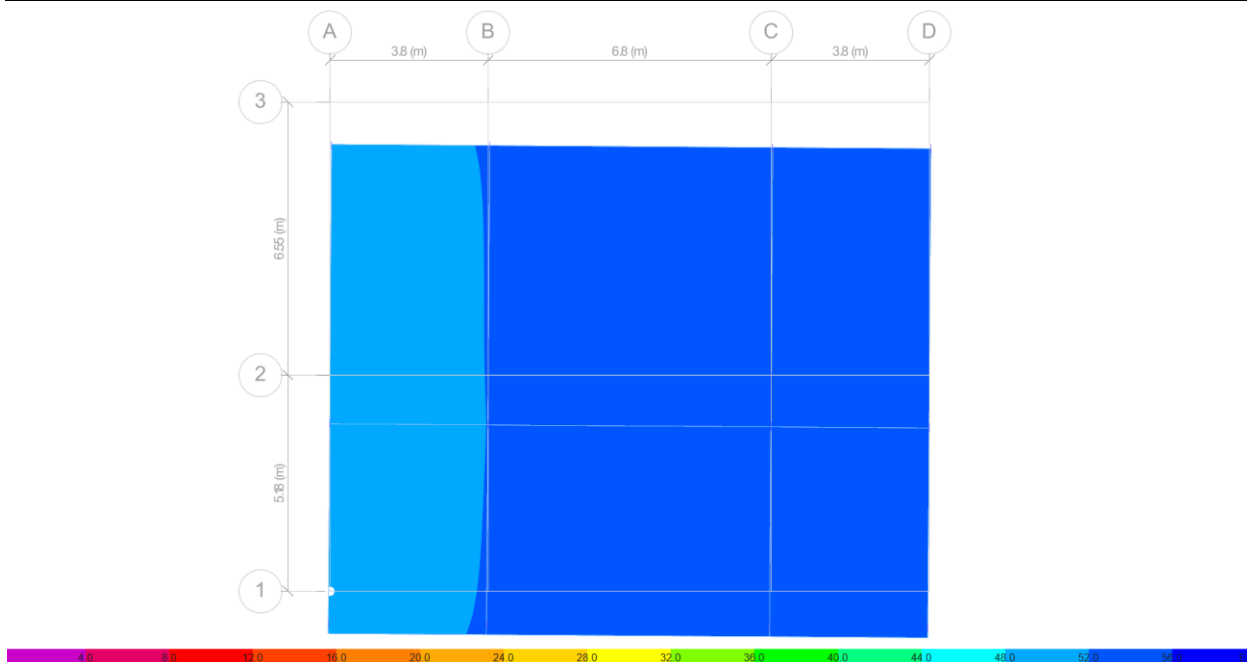
Figura 4-7: Forma e tonit 2 të Ndërtesës me 3 kate – 0.61 sek [mm]
