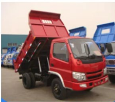
Figura 3: Makina vetëshkarkuese që mund të përdoren për lëvizjen e dherave dhe rrotullat e membranave.
