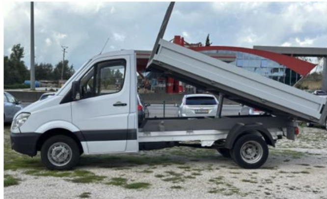
Figura 3: Makina vetëshkarkuese që mund të përdoren për lëvizjen e dherave dhe rrotullat e membranave.
