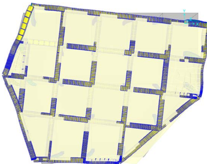
Figura 20 – Forma e tretë modale, T=0.2248s
