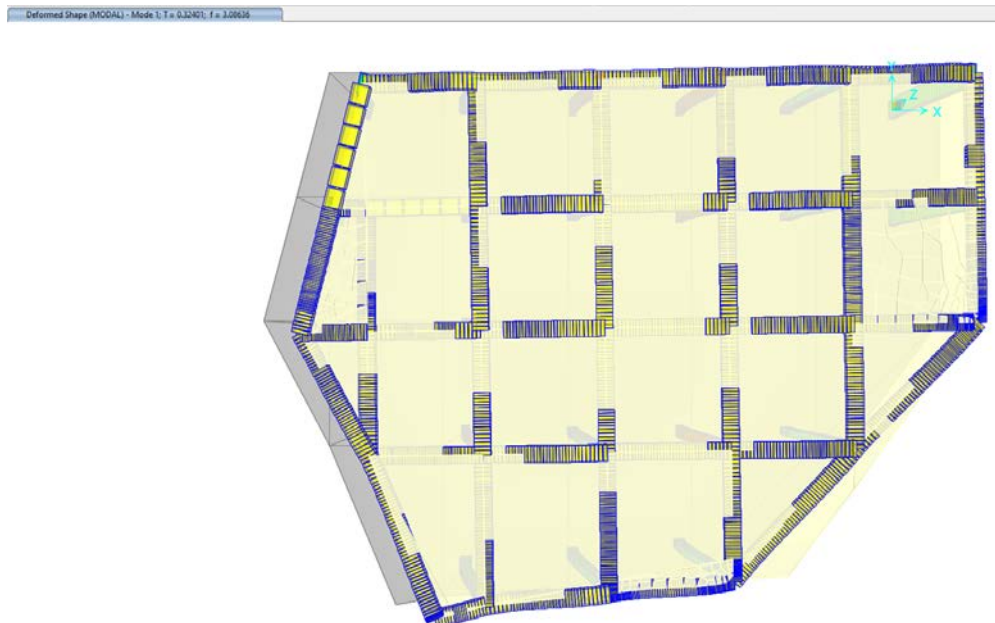
Figura 18 – Forma e parë modale, T=0.3240s
