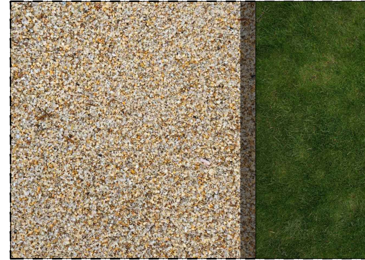
DETAJI 4__Fragment shtrimi me zhavorr pa argjile per absorbimin e goditjeve
