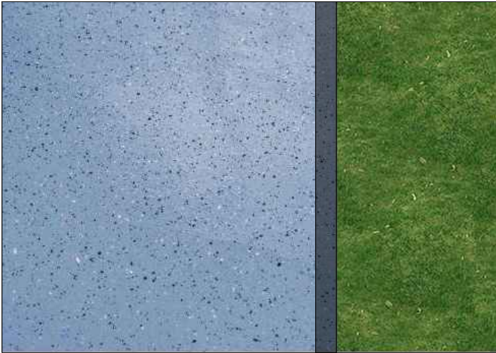
DETAJI 3__Fragment shtrimi beton me agregat ne dukje dhe gjelberim
