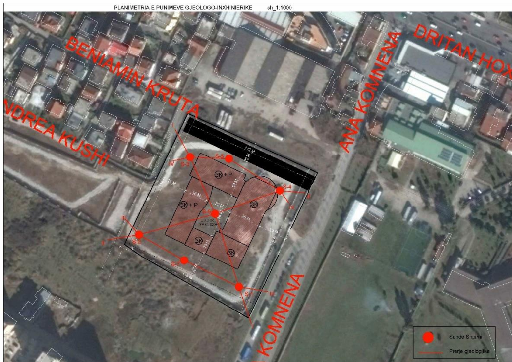
Fig. 1: Planimetria e punimeve gjeologo-litologjike ne sheshin e ndertimit ne Rr. “Ana Komnena” (Allkja, 2015).
