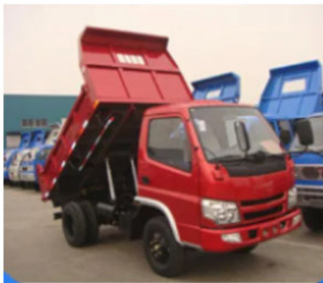
Figura 8: Makina vetëshkarkuese që mund të përdoren për lëvizjen e dherave dhe rrotullat e membranave.
