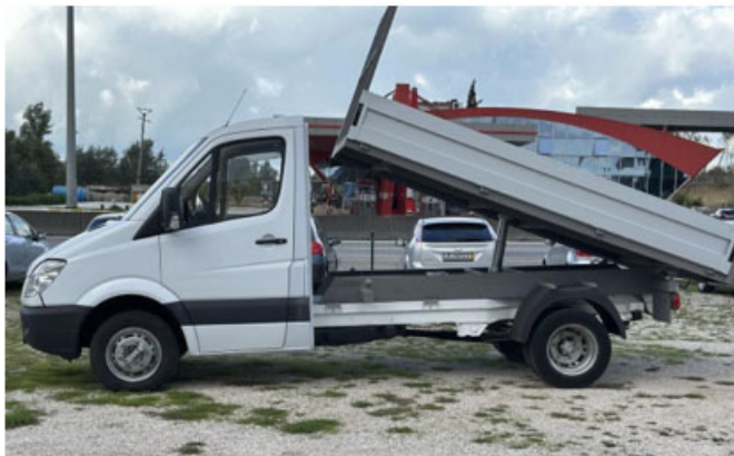
Figura 8: Makina vetëshkarkuese që mund të përdoren për lëvizjen e dherave dhe rrotullat e membranave.
