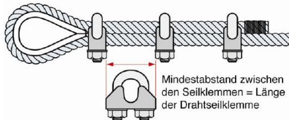
Figura 9-1: Distanca minimale e mbërthyesve të kavove.
