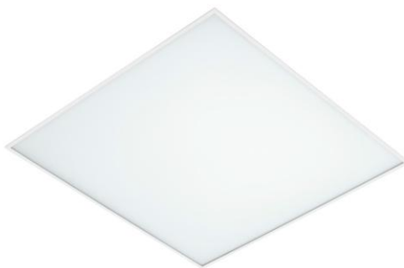
Figura 8 : Ndricues kator panel LED 39W, 60x60cm, IP54, me difuzor mikroprizmatik, inkaso i perdorur ne ambientet dhomes te pacientit 3 te reaminacionit
