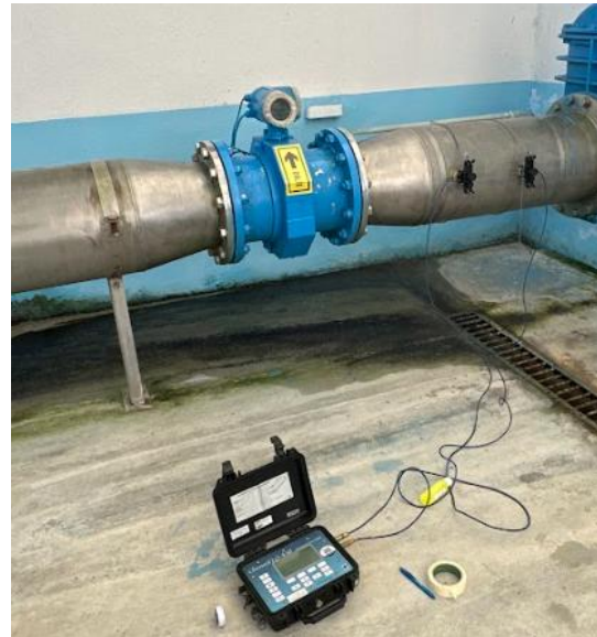
Figura 12: Matja e prurjes në tubin e dërgimit DN700
