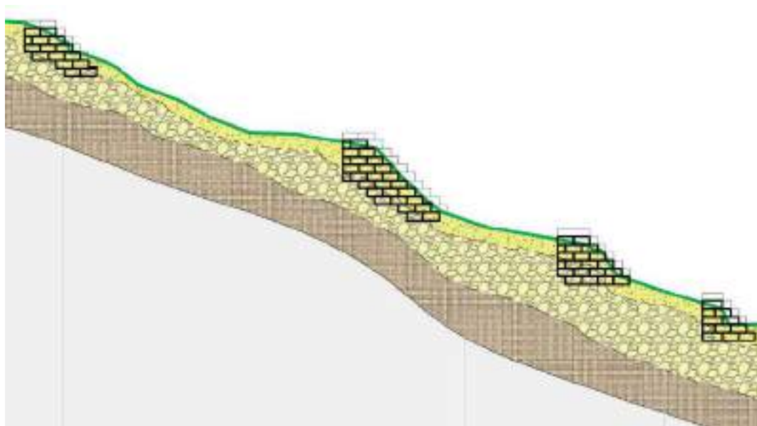
Pozicionimi ne planimetri dhe profil gjatesor i pritave egzistuese ne piketat 6,8,9,10
