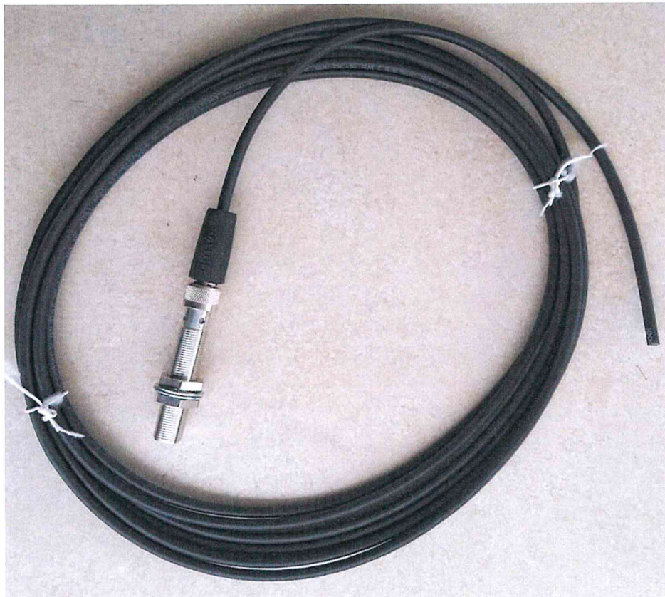
Foto ilustruese e nje Sensori Induktiv, Model BES M12MI – PSC40B – S04G , bashke me kabllin 5 m dhe connector-in M12x1, Male, 3-Pin te montuar ne Sensor
