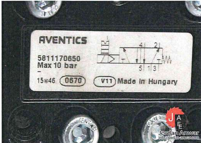
3(tre) Pamje te ndryshme ku tregohen te dhena te stampuara ne trupin e elektro-valvules se ajrit
