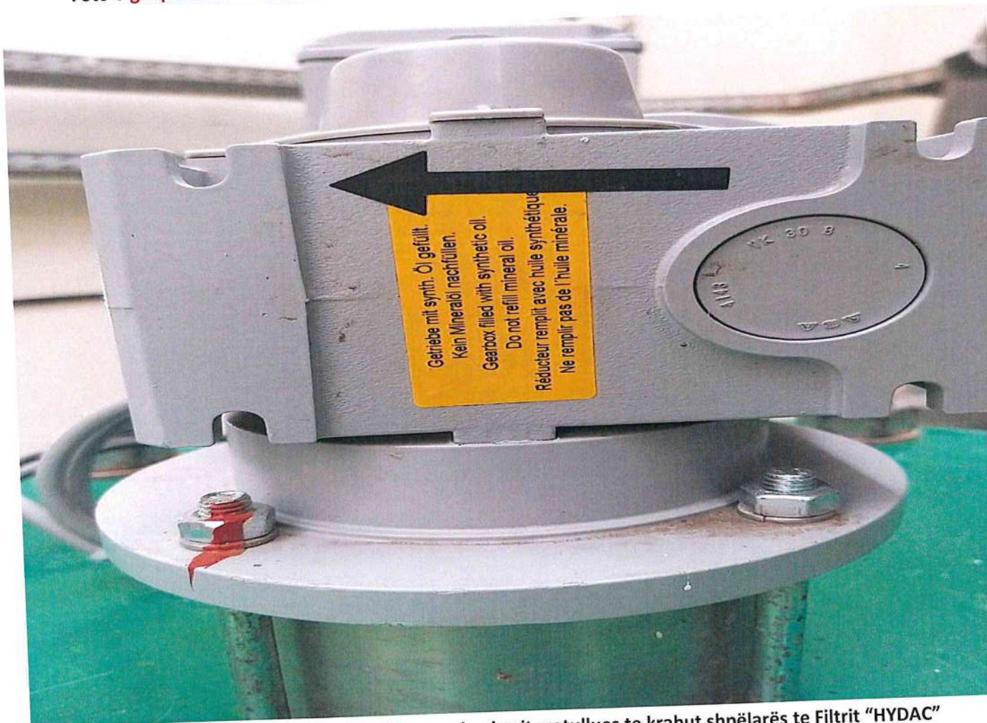
Foto e grupit motor-reduktor te mekanizmit rrotullues te krahut shpëlarës te Filtrit "HYDAC"
