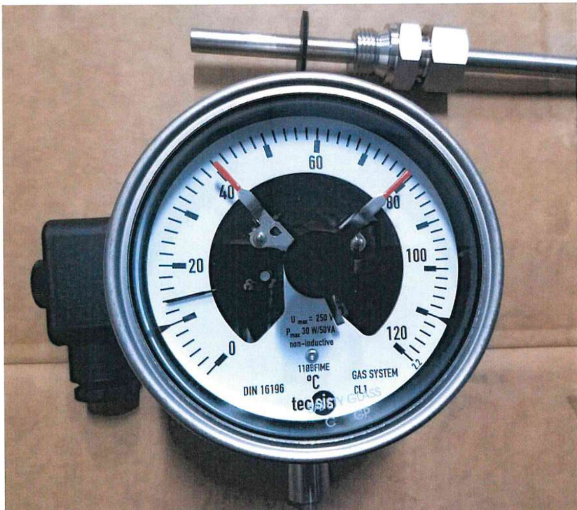
Foto e pjesshme se aparatures se termometrit me kontakt Model TM870 , qe perdoret per matje tek segmentet e KDGI-se
