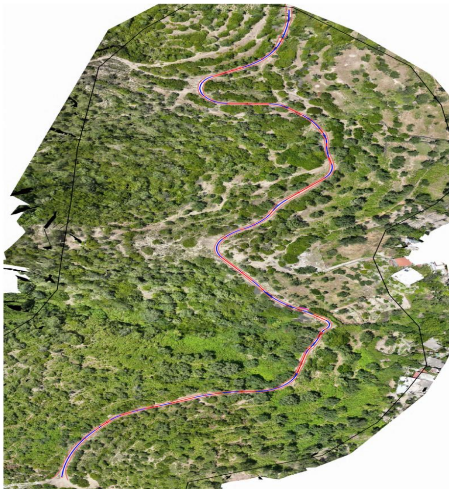
Figura 7. Planimetri e segmentit rrugor bujqësor Piqeras aksi- 2. Dokumentacioni teknik / ortofoto.
