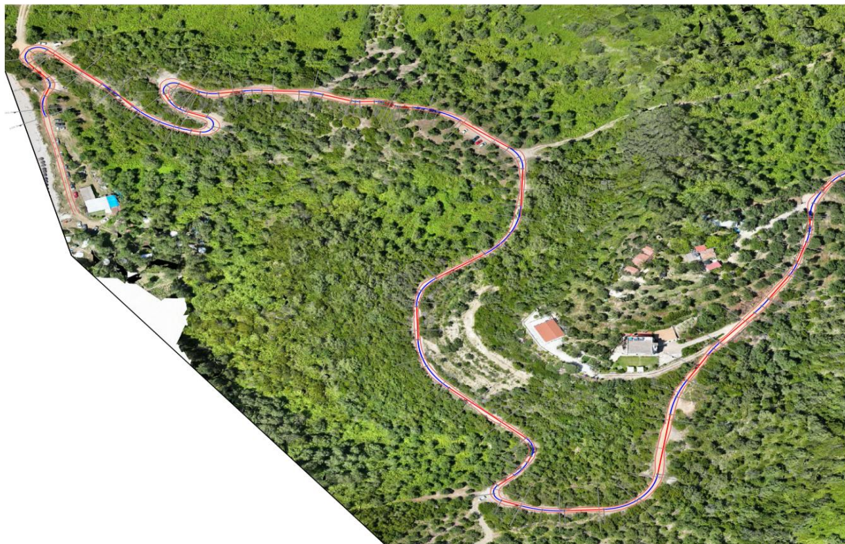
Figura 4. Planimetri e segmentit rrugor bujqësor Lukovë Aksi-I, Dokumentacioni teknik / ortofoto.
