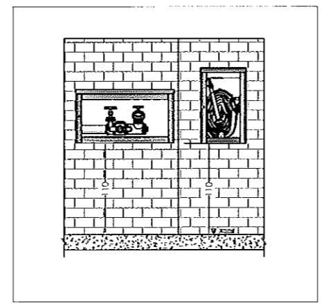
Detaj i montimit te hidrantit dhe motopompes
