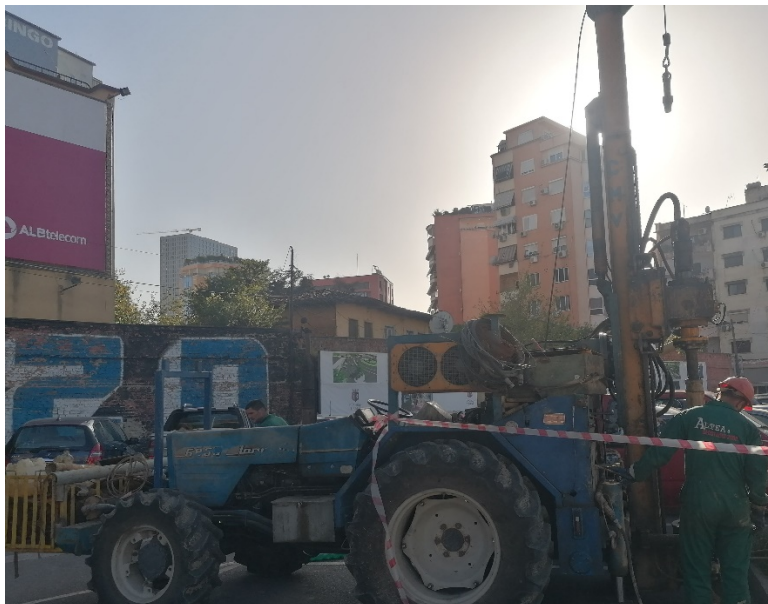
Foto nr.6 Pozicioni i sondes gjate kryerjes se shpimit BH-2
