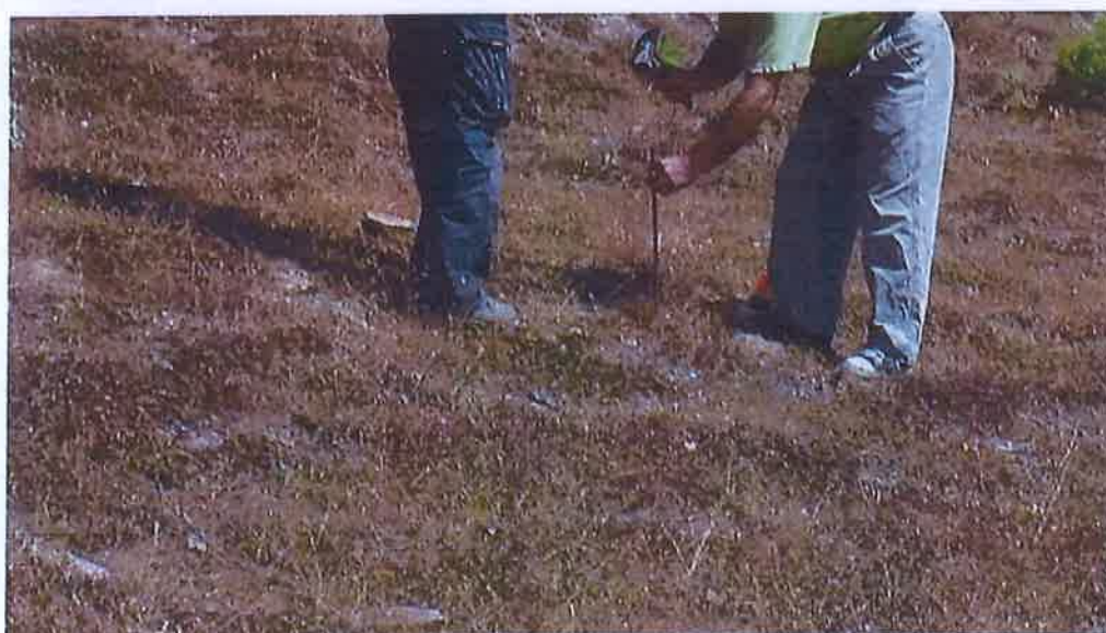
Foto gjate rilevimit dhe vendosje se BM me kunjja metalke per reference
