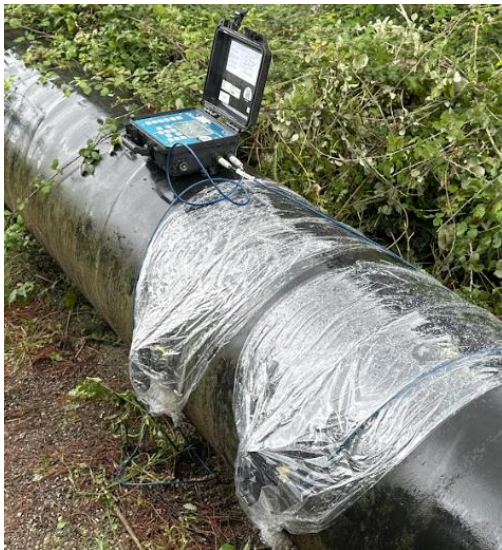
Figura 28: Matja e prurjes në tubin kryesor që sjell ujë në depot
