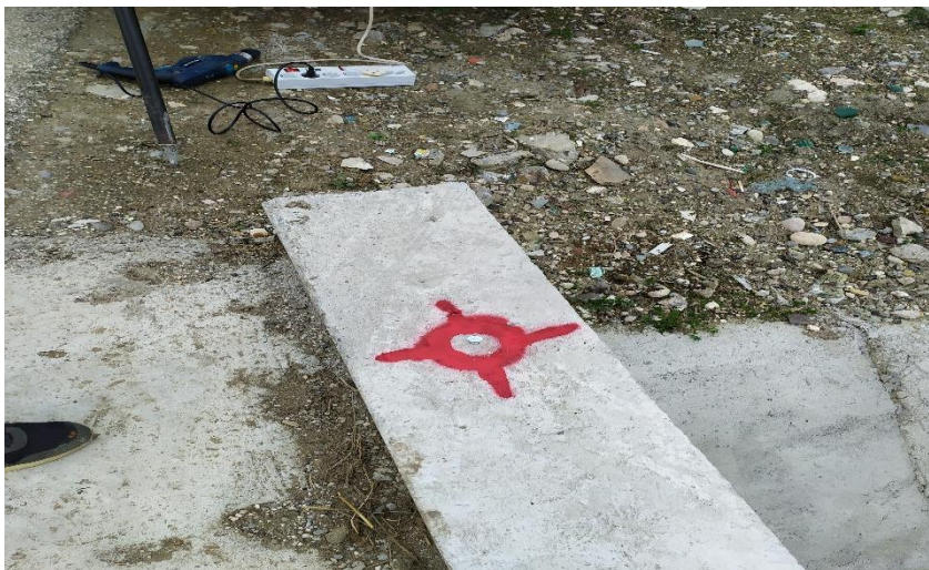
Fig.28 (Pike e Bazamentit Gjeodezik)
