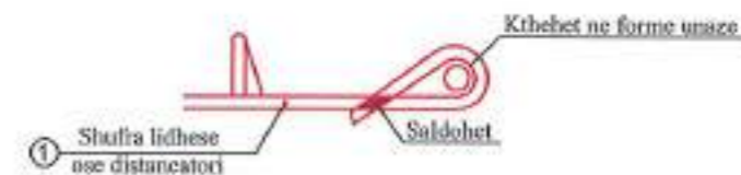
Detaji i fiksimit te shufrave lidhese dhe distancatoreve
