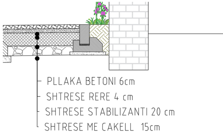
Figura 12 – Paketa e shtresave ne trotuare
