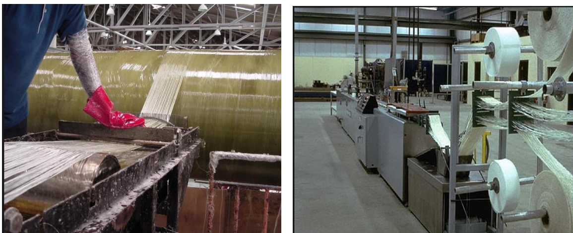
Figura. Proçesi i prodhimit te fibrave CFRP nëpërmjet gërshetimit
