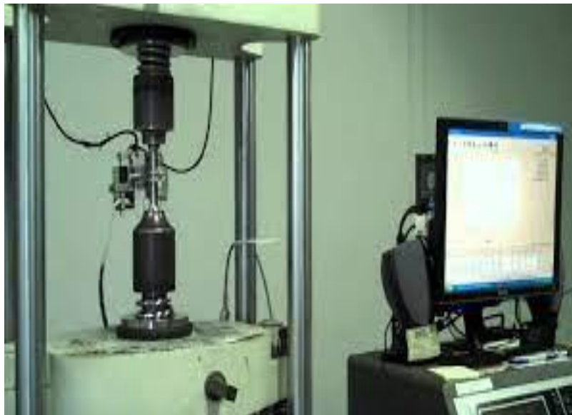
Fig. Procesi i testimit te hekurit ne presen hidraulike
