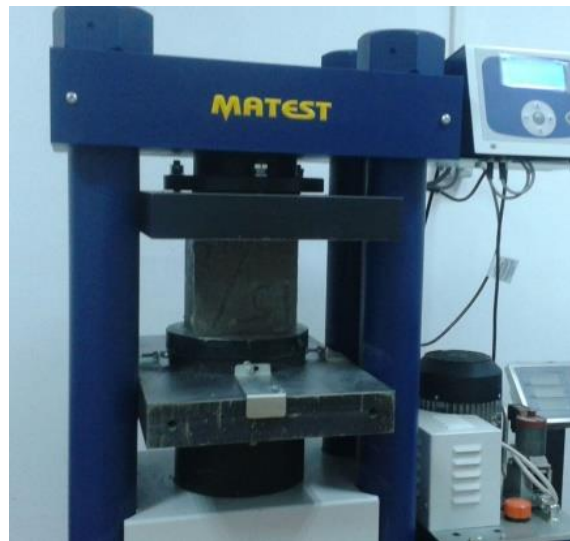
Fig.1 Kubike betoni dhe shkatërrimi i tyre në presen hidraulike
